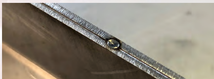
Bodování - materiál nerez 1,5 mm
