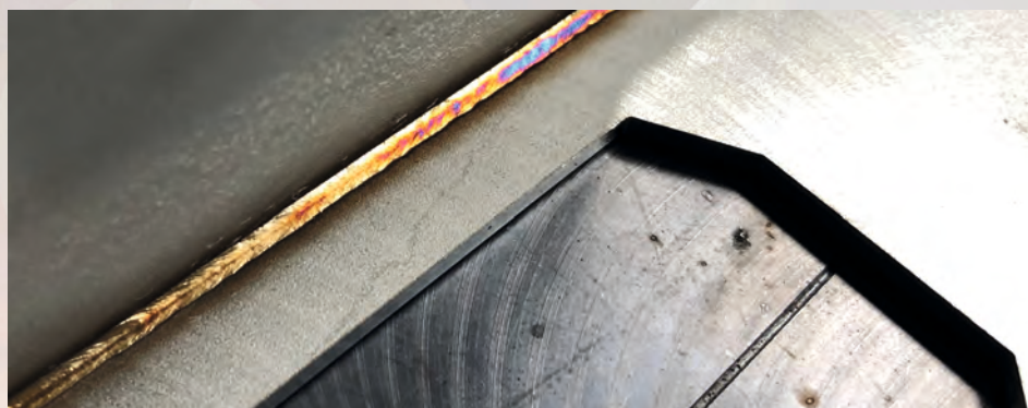
Koutový svar - materiál nerez 3 mm
